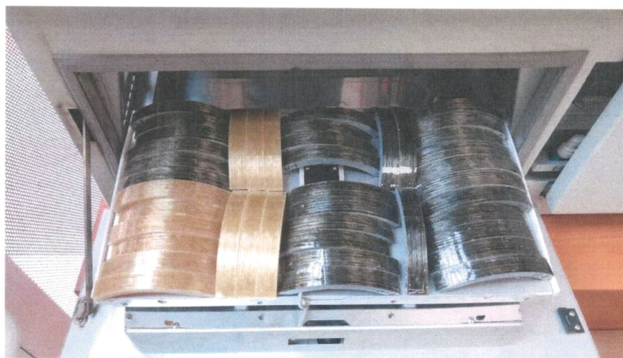
Рисунок 1 — Общий вид образцов в камере везерометра
