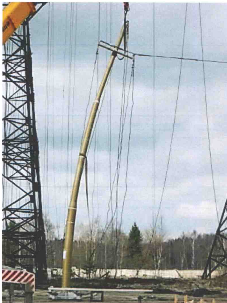
Горизонтальная нагрузка 1500 кгс
